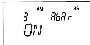
2 ダイヤルを回すと「ON」から「OFF」になり、外部アンテナが使えます。
