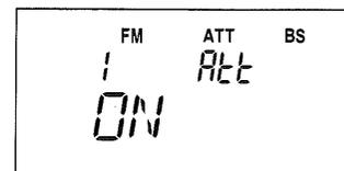
**参考** SMAアンテナコネクタからつなぐアンテナ(付属または外付けアンテナ)を使用しているときのみ有効になります。通常は「OFF」でお使いください。
