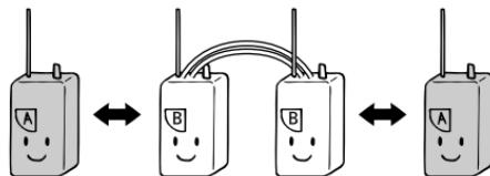
直接の通信ではつながらない相手と、中継器を介してモード2（同時通話モード）のように通信するモードです。
