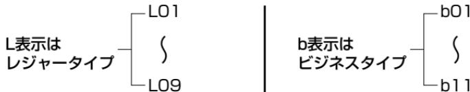
L表示のチャンネルでは、従来のレジヤータイプ（9チャンネル機）と通信できます。
