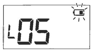
**メモ** 「電源が入らない」「オンオフを繰り返す」「ディスプレイの表示が消える」などの症状が出た場合も電池の消耗が考えられるため、バッテリーを充電、もしくは新しい電池と交換してください。
