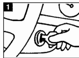
車のエンジンをかけ、アイドリング状態にし、本機のシガープラグを車のシガーソケットに差し込んで下さい。
