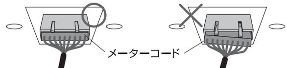
安全キーをメーター中央左下の安全キーセット位置に置き、パルスセンサーをメーター左下のパルスセンサー差込口に、差し込みます。
