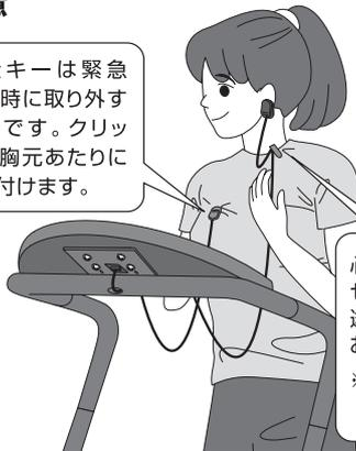
心拍数を測定する時にはパルスセンサーを耳たぶにはさみます。途中のクリップを襟元で固定しておきます。
