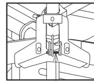
センターフレームと、上下のフレーム受け金具を、脱落防止ボルトで固定します。
