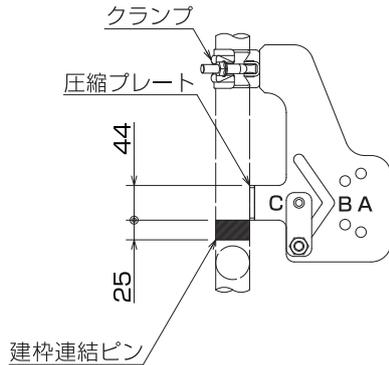
Ⓐ：防音パネル使用時 Ⓑ：養生枠使用時 Ⓒ：シート使用時
