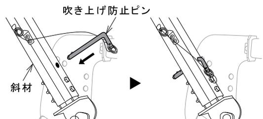
斜材受け金具の穴に吹き上げ防止ピンを通します。
