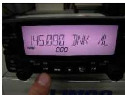
③ 反対側のダイヤルを回して145.080、000を選ぶ。そのダイヤルを長押しする。点滅が止まる。間違えたときはダイヤル長押しすれば点滅になる。
