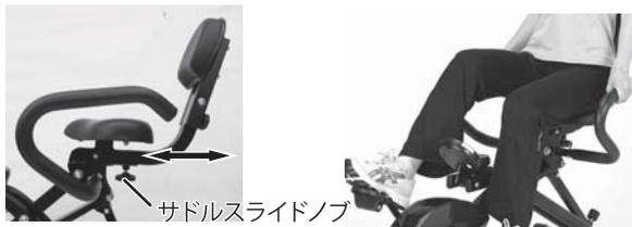
注意：組立手順3-③でサドルフレーム固定用ボルトを強く締め過ぎているとサドルの前後調節が固くなります。サドルフレーム固定用ボルトはナットと面一になる程度に締めてください。
