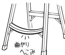
④各部の接合部に割れやいちじるしい腐食がありませんか。また、取り付け部品の破損・脱落・変形・磨耗・いちじるしい腐食がありませんか。ある場合は、絶対に使わないで廃棄してください。
