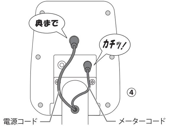
※組立完了後、表示メーターが作動しない場合は、組立手順4・7のコードの接続をもう一度確認してください。
