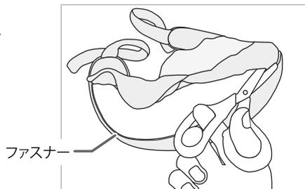
2. カバーを外し、緩衝材を剥がすと、リチウムイオン充電電池があります。
