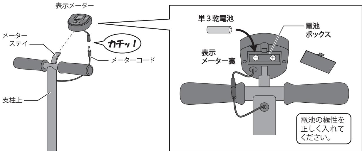
ステップ運動をおこなっても、表示メーターにカウントされない場合は、組立手順3・4のメーターコードの接続箇所(2ヶ所)を再度確認してください。
